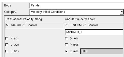
an unserem Pendel, oder am Drehgelenk angegeben werden. In beiden Fällen wählen wir durch Rechtsklick im Menü den Punkt „Modify“ aus, entweder für das Pendel oder das Gelenk. Beim Pendel muss zusätzlich der Drehpunkt angegeben werden (muss nicht MARKER\_1 sein, vorher überprüfen).
