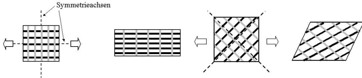
(a) Belastung eines orthotropen Werkstoffs in den Symmetrieachsen (b) Belastung eines orthotropen Werkstoffs außerhalb der Symmetrieachsen
