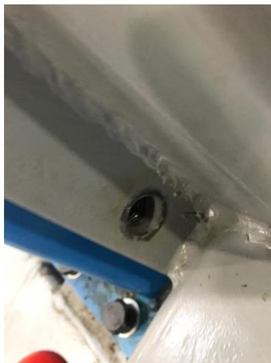
Fehlende demontierte Netzzuleitung. Zur Inbetriebnahme sollte der Hydraulikbehälter überprüft werden, sowie das Hydrauliköl gewechselt werden.
